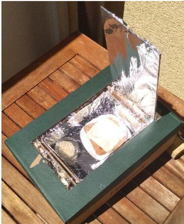
Durch Anbringung des Deckels ist der Solarofen fast fertig. Am oberen Ende des „Spiegels“ kann ein Loch für die Befestigung einer Schnur gemacht werden. Zwei Schrauben, die auf der Rückseite der Kartonbox eingeschraubt werden, können als Befestigung dienen. Damit kann der Brennpunkt des Reflektors immer auf die Mitte des Kochraums ausgerichtet und angepasst werden. Zusätzlich kann der Solarofen am hinteren Ende leicht erhöht aufgestellt werden, um so noch mehr Sonnenstrahlen einzufangen.
