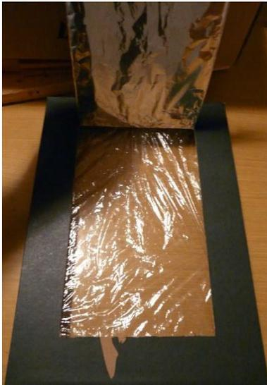
c) Der ausgeklappte Deckel soll als Reflektor dienen. Dazu wird er auf der Innenseite mit Alu-Folie bedeckt.
