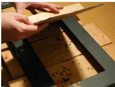
b) Mit zuhilfenahme eines Holzes wird der Deckel nun an einer geraden Kante herausgeklappt.
