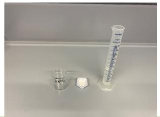
Um die Elektrolytlösung zum Umfärben des beschichteten FTO Plättchens herzustellen, werden 4,04 g KNO3 mit 40 ml destilliertes Wasser vermengt.
