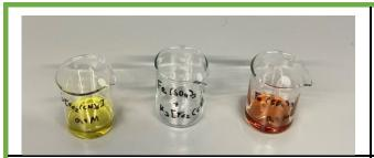
Es werden 20 ml 0,1 M Eisen (III)sulfat und 0,1 M Kalium-Hexacyanoferrat (III) in das 100 mL Becherglas gegeben.
