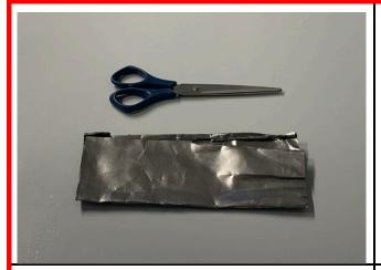
Es wird wiederum ein Grafitfolie in der Größe des FTO-Glases vorbereitet. Diese wird wieder in die rote Krokodilklemme geklemmt.
