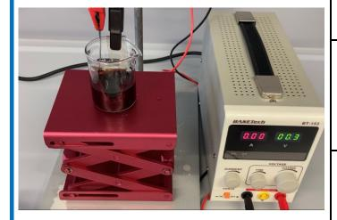
Das FTO-Glas wird an die schwarze Krokodilklemme gehängt und die Grafitfolie an die rote Krokodilklemme. Die Kabel werden mit den Klemmen und mit dem Netzteil verbunden.
