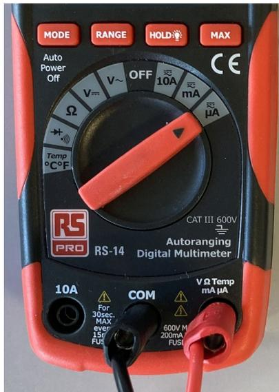
Um Strom zu messen wird der rote Stecker bei  $\mu A$  eingesteckt. Der schwarze Stecker wird bei COM eingesteckt. Der Regler in der Mitte wird auf mA gestellt.
