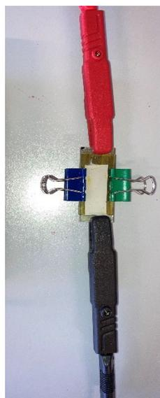
Mit einer Taschenlampe wird die Solarzelle beleuchtet und der gemessene Strom notiert.
