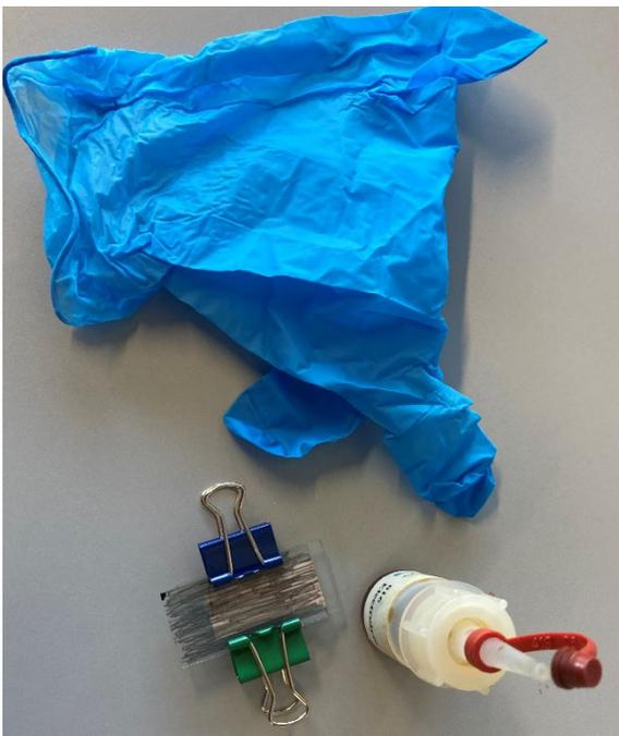
Zwischen die Platten werden mit Hilfe der Einwegpipette 0,15- 0,25 mL des Iodolytes gegeben.
